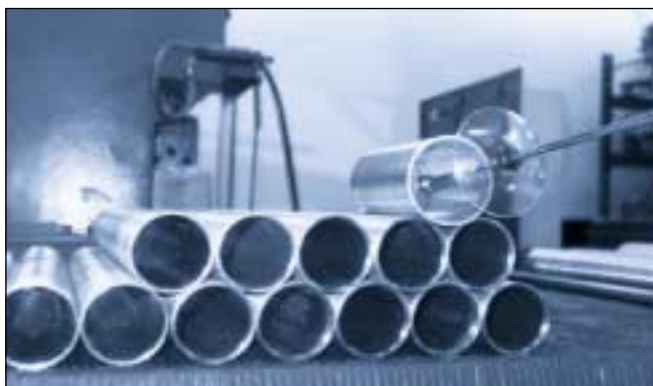
La photo ci-dessus montre le nettoyage par soufflage de tuyaux cylindriques. Une buse SILVENT 910 a été montée sur un pistolet de soufflage équipé d'un bouclier de sécurité.
