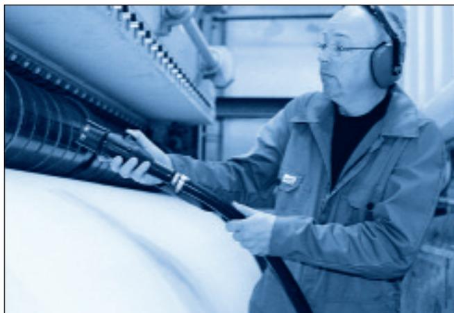
La torche Silvent 4015-L avec « poignée homme mort » est utilisée pour le nettoyage en sûreté d'un laminoir. La commande « homme mort » garantit la fermeture immédiate de la vanne si l'opérateur laisse tomber l'outil.
