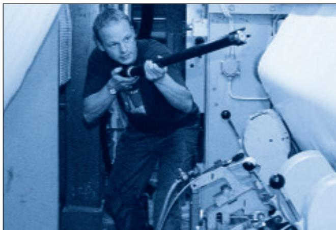
La photo montre une application de nettoyage dans une papeterie. Une Silvent 4015-LF-1000 est utilisée pour offrir à l'opérateur une position de travail plus ergonomique et lui permettre d'accéder à l'intérieur de la machine
