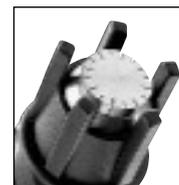
Les Silvent 4115 et 4120 sont équipées d'une buse à effet Laval en inox qui offre des caractéristiques de soufflage uniques. Le jet d'air central est généré par la buse à effet Laval qui convertit toute l'énergie emmagasinée dans l'air comprimé en énergie cinétique sans que le jet d'air se propage latéralement une fois passé à travers la buse. Breveté. **Répond entièrement aux exigences de limitations sonores de la Directive Machines de l'U.E. et aux normes de sécurité OSHA.**
