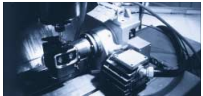
La photo ci-dessus montre une lame d'air qui nettoie une machine CNC utilisée pour l'usinage de la pièce latérale du boîtier des appareils photographiques chez Hasselblad.
