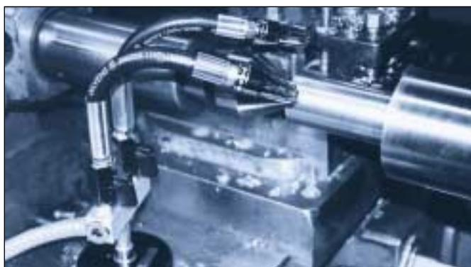
La photo ci-dessus montre une application avec une embase magnétique double SILVENT 232. Les buses de soufflage sont utilisées pour le nettoyage de pistons de grand diamètre pendant le tournage. L'embase magnétique, équipée de 2 FLEXTUBES, permet un réglage précis et rapide de l'angle de soufflage.
