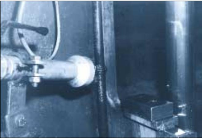
Alu-Norf, une des plus importantes sociétés allemandes de recyclage d'aluminium, utilise de nombreux types de buses de soufflage SILVENT dans sa production. Ici une torche SILVENT 1207 est utilisée pour l'évacuation d'émulsion dans le processus de fabrication d'aluminium.
