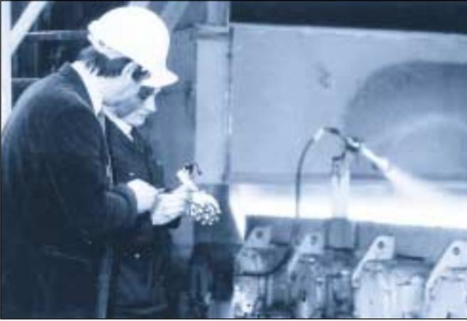
La série 1200 SILVENT a résolu les problèmes d'eau et de scories sur ce laminoir chez British Steel. Particules et eau sont efficacement balayées lors du passage de l'acier dans le jet d'air. Le soufflage à tuyau ouvert précédemment utilisé nettoyait imparfaitement l'acier.
