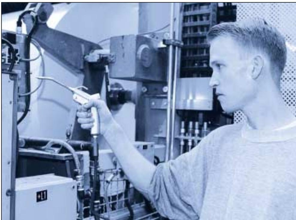
La photo montre le pistolet SILVENT 2050-S utilisé pour le nettoyage global dans l'industrie agroalimentaire. La série 2000 est une gamme de pistolets de soufflage en aluminium extrêmement résistants et pratiques. Ils conviennent dans les cas où les pistolets sont malmenés et la résistance fondamentale.
