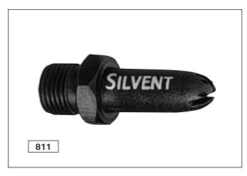
La SILVENT 811P est une buse en "PEEK" avec un orifice central, qui peut s'utiliser dans des environnements chimiques agressifs, résiste aux liquides de coupe corrosifs et aux températures jusqu'à 260° C (500° F). Raccord 1/8". Spécifications techniques supplémentaires indiquées dans le tableau ci-dessous. Répond entièrement aux limitations sonores de la directive Machines de l'UE et aux normes de sécurité OSHA.
