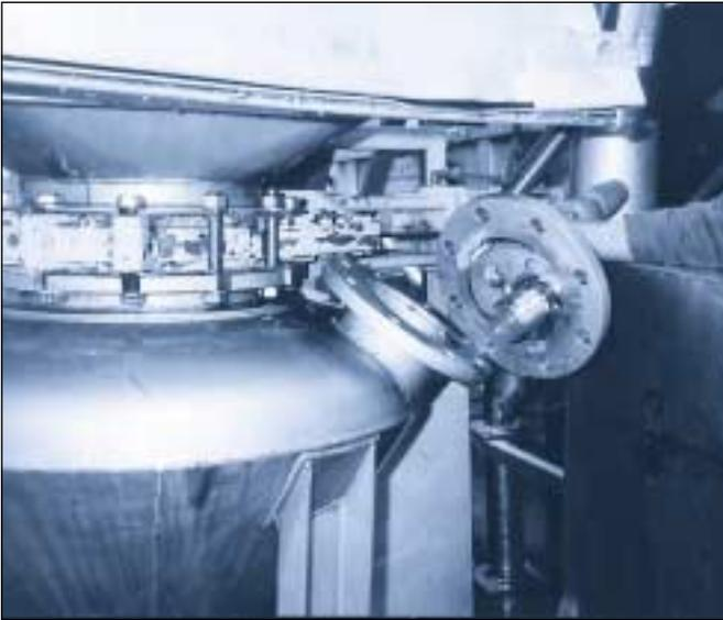
Dans cette application, la buse inox Silvent 720 débarrasse une machine à découper les filets des déchets de poisson. L'installation Silvent a remplacé un tuyau ouvert qui générait un niveau sonore de 102 dB(A). La buse 720 a réduit le niveau sonore à 79 dB(A) et donne une force de soufflage plus que suffisante.
