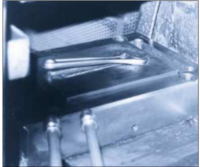
Sandvik Bacho utilise 2 SILVENT 705 pour décoller de son support une clé anglaise d'un kilo. Autrefois, on utilisait des tuyaux ouverts de 10 mm. L'installation des buses Silvent a réduit de moitié le niveau sonore et la consommation d'air a diminué de 49%. Avec un taux d'utilisation de 40%, cela représente une économie de plus de 850 USD par an.
