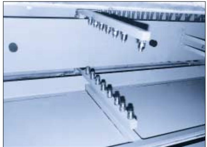
Fehrer à Kitzingen a construit plusieurs rampes d'air comprimé qui utilisent les buses inox Silvent série 700. La société est un fournisseur important de composants de l'industrie automobile en Allemagne. Pour garantir une qualité parfaite des composants livrés, chaque pièce est nettoyée par soufflage.
