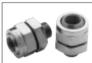
Un raccord orientable pour régler la direction du cône d'air. Le raccord permet un réglage simple et précis de l'angle de soufflage sans affecter le reste du montage fixe. Un réglage correct de l'angle de soufflage donne un niveau sonore inférieur et un meilleur rendement.
