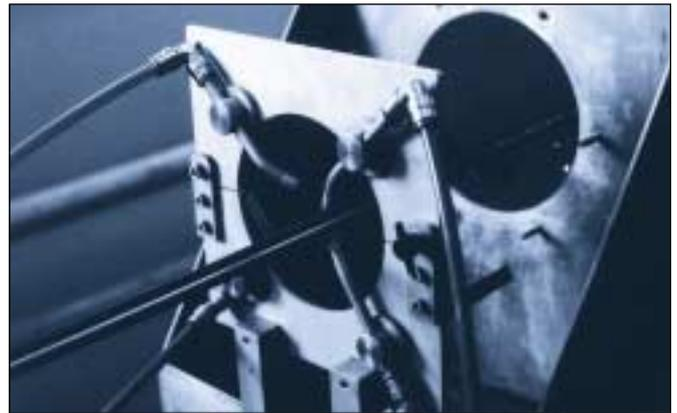
La photo montre quatre buses SILVENT 5001 montées autour d'un écarteur de bande plastique. Les buses séchent ces bandes au cours de la production. La société a constaté une diminution importante de la consommation d'air et une réduction du niveau sonore de 20% depuis la suppression du soufflage par tuyau ouvert.
