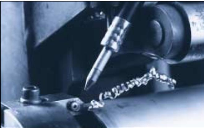
Nettoyage par soufflage sur un tour avec un FLEXTUBE et une buse 511.
