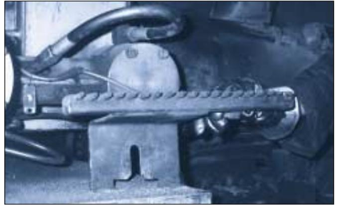
Nettoyage par soufflage après soudure. Un des plus grands fabricants de jantes d'Europe, Prins Dokkum aux Pays-Bas, utilise les buses SILVENT pour diverses opérations de soufflage. La photo montre une rampe avec des buses SILVENT 511. La rampe est utilisée pour nettoyer par soufflage les particules et déchets après soudure par points.
