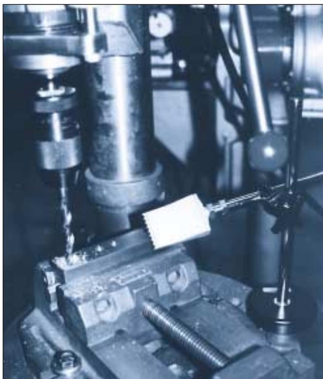
Utilisation d'un SILVENT 924 pendant une opération de perçage. Comme l'angle de soufflage doit être continuellement réajusté, le FLEXARM constitue l'outil idéal pour un réglage constant.
