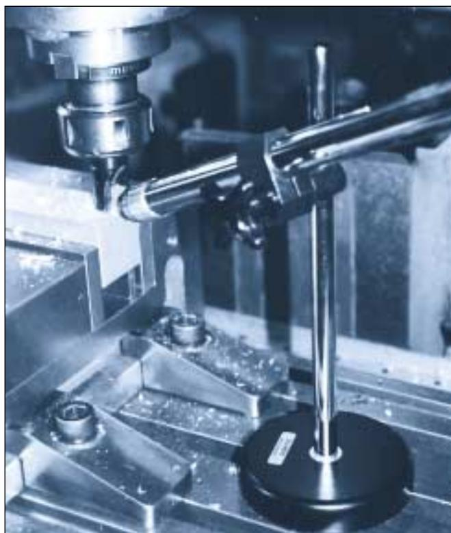
Utilisation d'un SILVENT 296 pour maintenir la machine à fraiser propre au cours de l'opération. Une molette permet d'ajuster facilement d'une seule main l'angle de soufflage dans sa position la plus silencieuse et la plus efficace.
