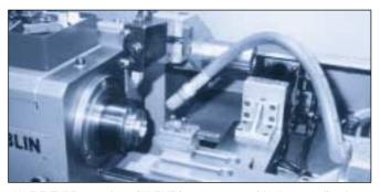
Un FLEXTUBE et une buse SILVENT forment une combinaison très silencieuse et efficace dans les applications de tournage.
