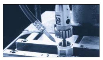
Refroidissement et nettoyage par FLEXTUBE 640 pendant une opération de taraudage.
