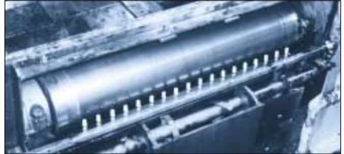
Rampe de buses SILVENT 209 séchant une feuille de métal dans une aciérie aux États-Unis. Autrefois, un tuyau ouvert aplati était utilisé. Le bruit a été divisé par deux et l'installation a été remboursée en trois mois grâce aux économies d'air comprimé.
