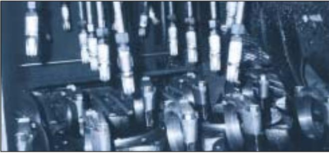
Suzuki Motors au Japon utilise les buses 209 pour le nettoyage et le séchage des composants moteurs. Avec les buses SILVENT, la société a fortement réduit le niveau sonore et la consommation d'énergie.
