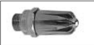
Les buses 215 et 216 sont en aluminium, avec un traitement de surface au nickel pour supporter les environnements contraignants. Les autres performances et dimensions sont identiques à celles des SILVENT 208 et 209. La buse 215 a un raccord femelle de 1/4" et la buse 216 a un raccord mâle de 1/4".
