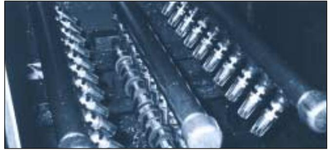
Les buses SILVENT 216 sont ici utilisées pour sécher des arbres à cames. À chaque poste de séchage, environ 50 buses permettent de sécher efficacement les arbres à cames.
