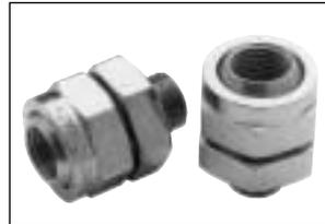
Raccord orientable pour régler la direction du cône d'air. Le raccord permet un réglage simple et précis de l'angle de soufflage sans affecter le reste du montage fixe. Un réglage correct de l'angle de soufflage donne un niveau sonore inférieur et un meilleur rendement.
