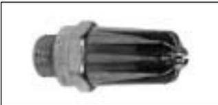
La buse de soufflage 209-S1 est une buse 209 avec au centre une fente de 1 mm de large et 4,5 mm de long. La buse génère un jet d'air puissant et concentré. Niveau sonore : 89 dB(A), Force de soufflage: 5N (17.7 oz), Consommation d'air : 24 Nm<sup>3</sup>/h (14.1 scfm). Autres performances et dimensions identiques à celles de la buse 209. Matériau : zinc. Raccord : mâle 1/4". Attention ! La SILVENT 209-S1 ne répond pas aux normes de sécurité OSHA.
