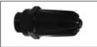
Les buses 217 et 218 sont en zinc recouvert de Rilsan. Le Rilsan donne une surface de contact plus douce et protège les produits sensibles des rayures en cas de contacts. Les autres performances et dimensions sont identiques à celles des SILVENT 208 et 209. La buse 217 a un raccord femelle de 1/4" et la buse 218 un raccord mâle de 1/4".
