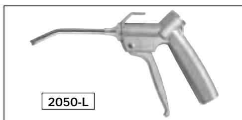
SILVENT 2050-L avec une buse à effet Laval est une alternative à la buse inox décrite ci-dessus. L'orifice Laval au centre de la buse assure d'excellentes propriétés de nettoyage. Ce pistolet convient pour des applications où l'exposition à l'usure mécanique n'est pas aussi élevée que dans les environnements nécessitant le 2050-S.
