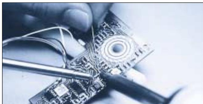
La photo ci-dessus montre une application où la Silvent MJ6 est utilisée pour le refroidissement par points et le nettoyage lors du soudage d'un circuit imprimé.
