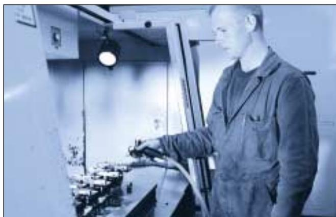
Le SILVENT 008 s'utilise avantageusement pour le soufflage efficace et rapide de grandes surfaces. La conception de la buse à ailettes crée un effet d'éjection et ainsi un soufflage puissant combiné à un niveau sonore faible.
