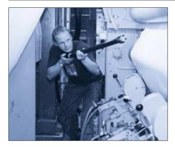
La photo montre une application de nettoyage dans une papeterie. Une SILVENT 4015-L-1000 est utilisée pour offrir à l'opérateur une position de travail plus ergonomique et lui permettre d'accéder à l'intérieur de la machine.
