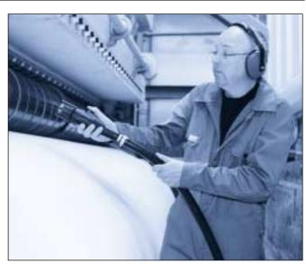
La torche SILVENT 4015-L avec "prise d'homme mort" est utilisée pour le nettoyage en sûreté d'un laminoir. La commande « homme mort » garantit la fermeture immédiate de la vanne si l'opérateur laisse tomber l'outil.
